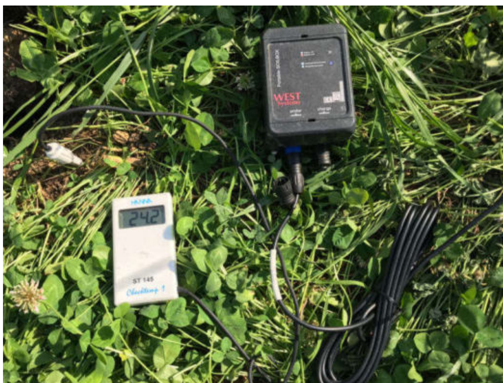
Figura 2.8 Strumentazione Soilbox portatile e termometro utilizzato durante il monitoraggio
