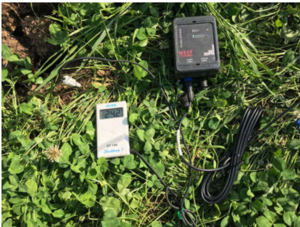
Figura 2.7 Strumentazione Soilbox portatile e termometro utilizzata durante il campionamento
